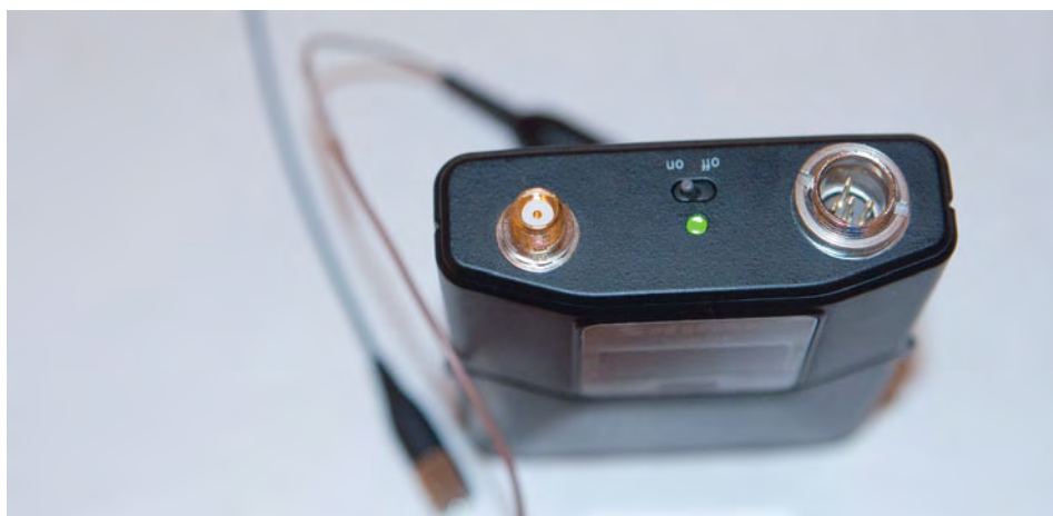
Sygnał analogowy wprowadza się do nadajnika ULXD1 poprzez gniazdo TA4F, obok którego znajduje się włącznik zasilania, a dalej gniazdo przykręcanej, grzałkowej anteny ćwierćfalowej.
