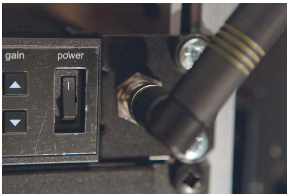
ULXD4 jest odbiornikiem typu „true diversity”, w którym wykorzystano technologię predykcyjnego przełączania anten.
