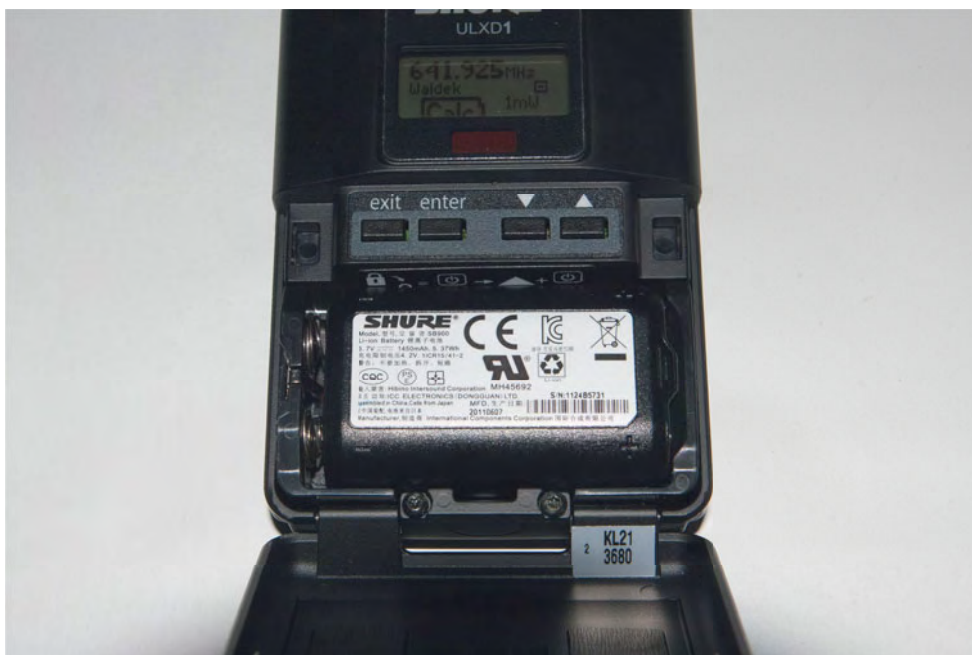
Obsługa menu ULXD1 odbywa się za pomocą czterech przycisków – dokładnie w taki sam sposób, jak np. w odbiorniku systemu PSM-1000...
