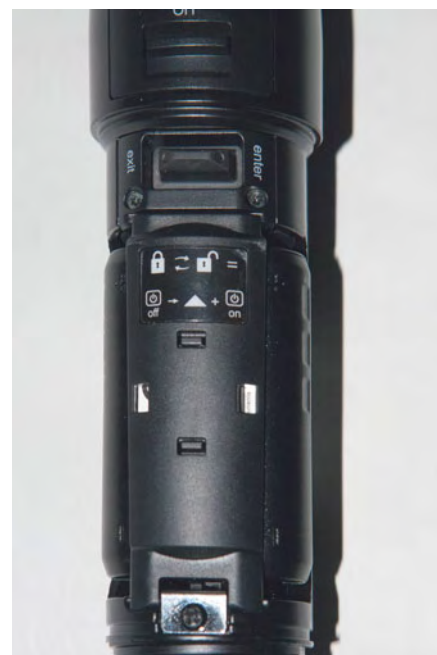
...zaś w ULXD2 służy do tego czterokierunkowy przełącznik, do którego dostęp uzyskuje się po okręceniu dolnej tulei obudowy.
