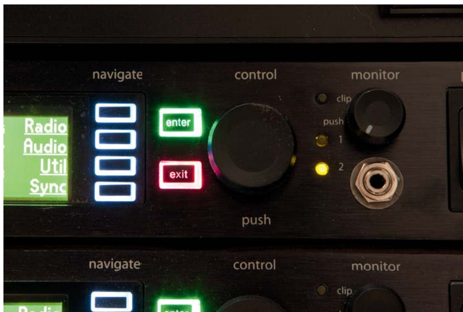
Sterowanie pracą nowego PSM-a i regulację parametrów umożliwiają wyświetlacze ciekłokrystaliczne wraz z zestawem przycisków pozwalających na poruszanie się po menu.
