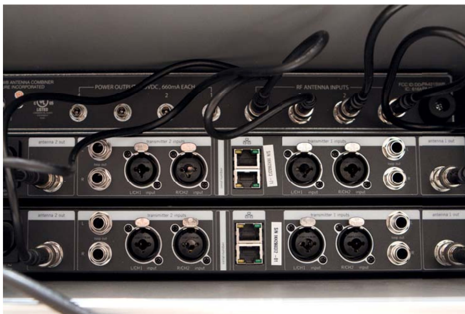
Z tyłu nadajnika znajdziemy gniazda antenowe, wejściowe (combo XLR/Jack) i wyjściowe (loop out jack ¼”) sygnału audio oraz sieciowe RJ45. Jest też oczywiście gniazdo zasilania.
