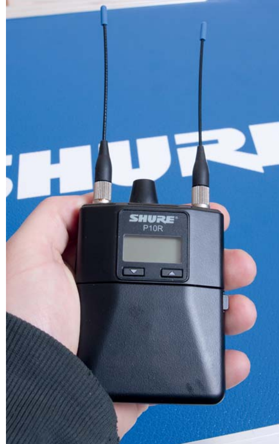
Odbiorniki systemów PSM 1000 i PSM 900 są na tyle do siebie podobne, że na pierwszy rzut oka można byłoby je pomylić, gdyby nie to, że pierwszy ma... dwie ćwierćfalowe anteny zamiast jednej!
