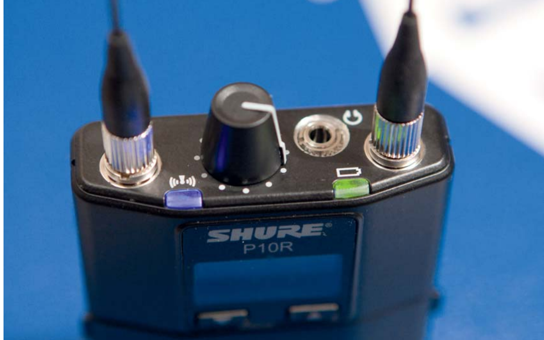
Dwa LEDy na obudowie P10R, trójkolorowy i niebieski, informują – odpowiednio – o stanie naładowania baterii i obecności sygnału radiowego.
