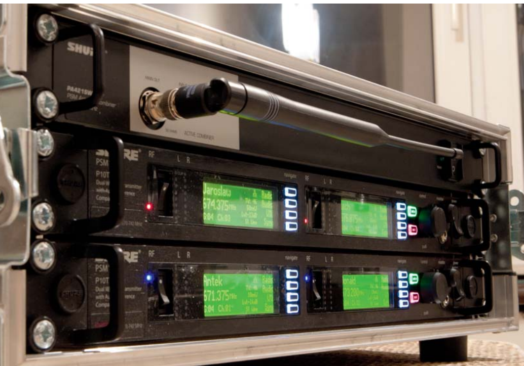
Anteny do nadajnika podłącza się za pomocą dodatkowych przewodów lub, jak w przypadku zestawu otrzymanego do testu, kombinera antenowego, wyposażonego w wyjściowe złącze antenowe z przodu.
