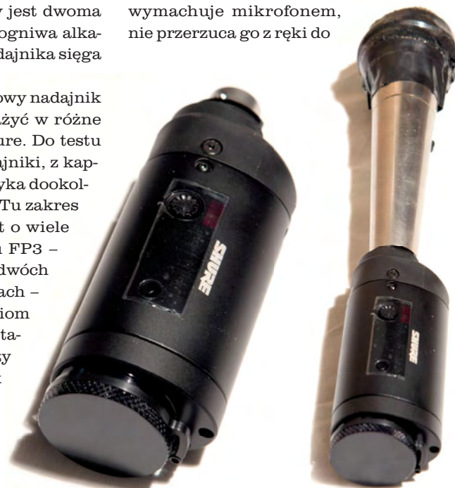
Rzadko spotykany typ nadajnika – plug-on, który umożliwia przekształcenie dowolnego mikrofonu dynamicznego ze złączem XLR w mikrofon bezprzewodowy.
