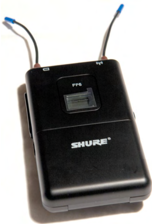
Odbiornik FP5 ma formę tradycyjnego nadajnika bodypack, bowiem przeznaczony jest do zamontowania na kamerze/aparacie, a więc musi być mały i lekki.
