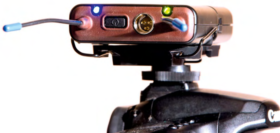
Odbiornik FP5 ma formę tradycyjnego nadajnika bodypack, bowiem przeznaczony jest do zamontowania na kamerze/aparacie, a więc musi być mały i lekki.
