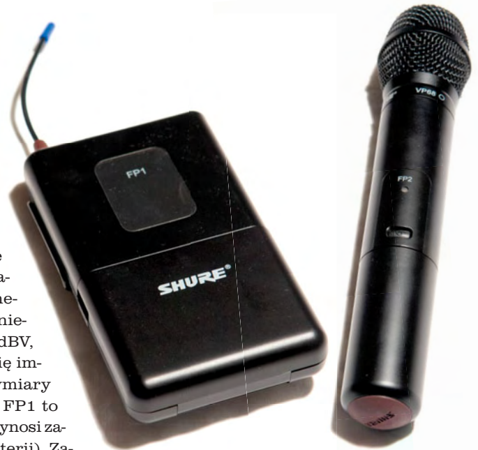
Dwa pozostałe nadajniki, FP1 i FP2, to już tradycyjne konstrukcje – odpowiednio, beltpack i handheld.
