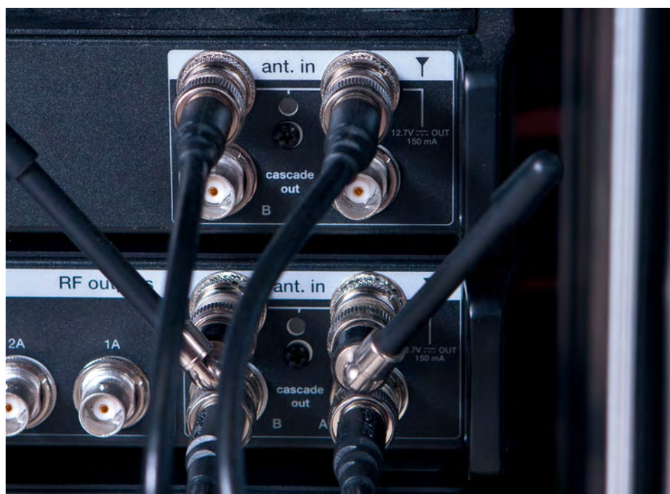
Na tylnym panelu odbiornika znajdują się gniazda antenowe wejściowe oraz kaskadowe, poprzez które sygnał antenowy można przesłać szeregowo do kolejnych czterech AXT400.
