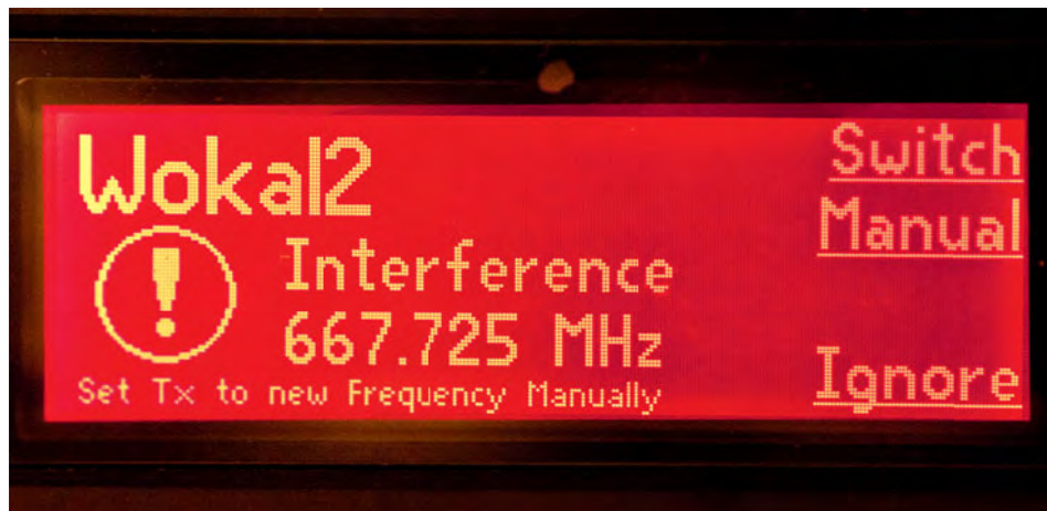
Jedną z najważniejszych funkcji odbiornika AXT400 jest mechanizm wykrywania zakłóceń, bazujący na podwójnym procesorze DSP.
