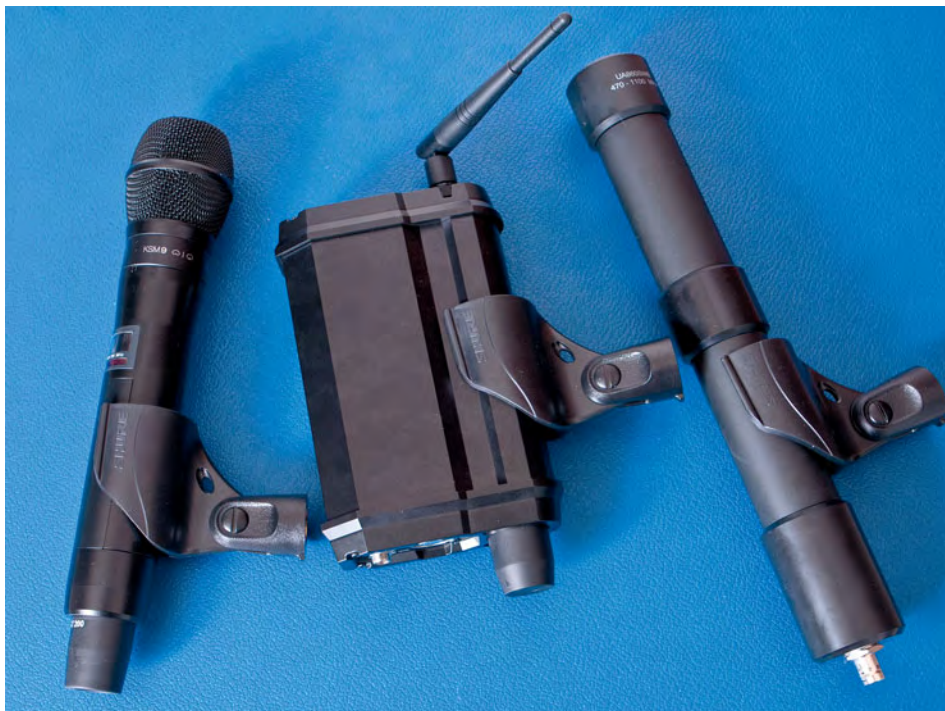
Zarówno nadajnik handheld ATX200, jak i punkt dostępowy AXT610 (w środku) czy antena są przystosowane do zamocowania w uchwycie mikrofonowym, dzięki czemu można je zainstalować na zwykłym statywie.
