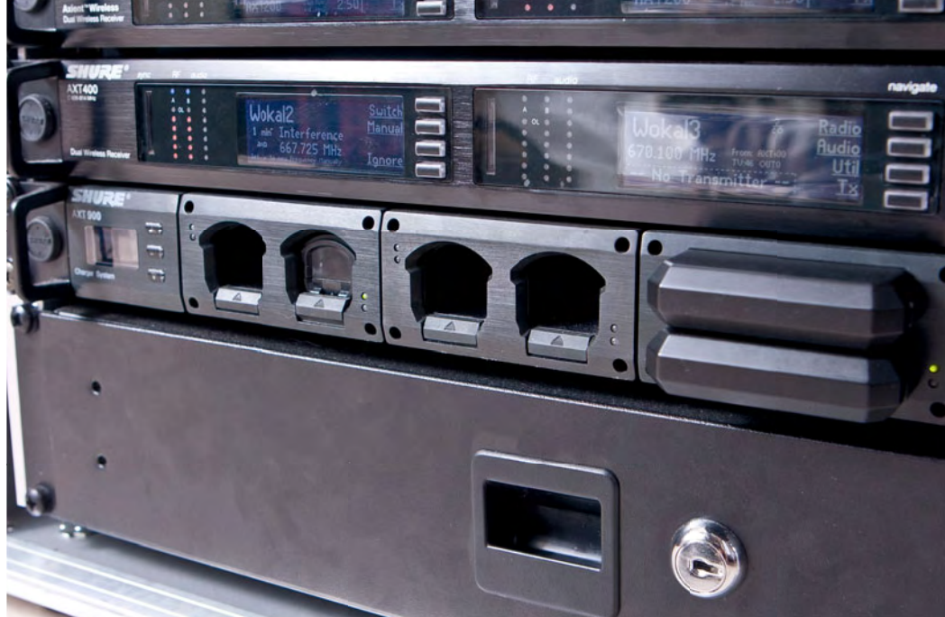
Kolejnym komponentem systemowym Axienta jest stacja ładowarek AXT900, pozwalająca jednocześnie ładować do ośmiu akumulatorów dla AXT200 i AXT100 lub ogniwi SB900.
