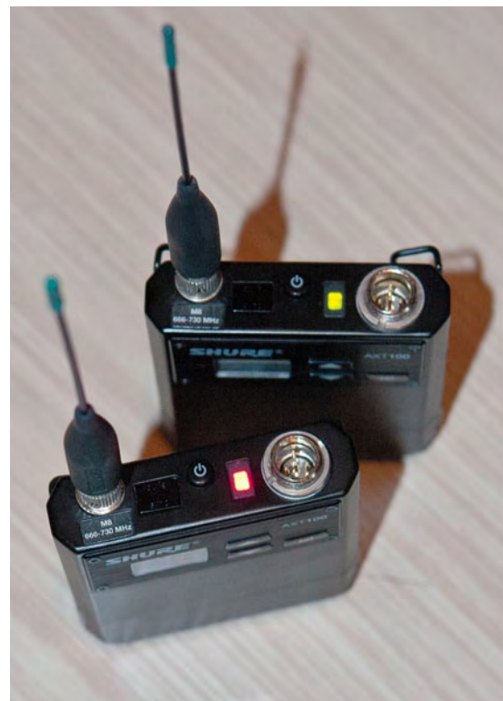
Sygnał audio wprowadzany jest do AXT100 poprzez standardowe gniazdo TAF4.
