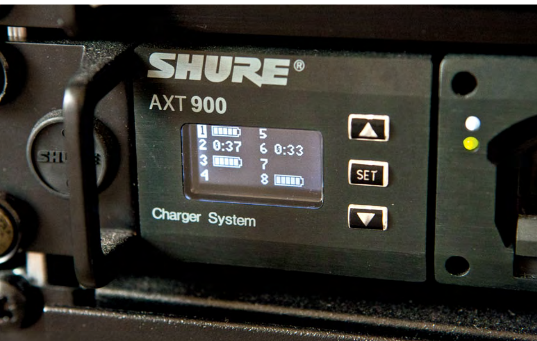
Nieduży wyświetlacz ATX900 informuje o czasie, jaki pozostał do uzyskania pełnego naładowania poszczególnych akumulatorów.
