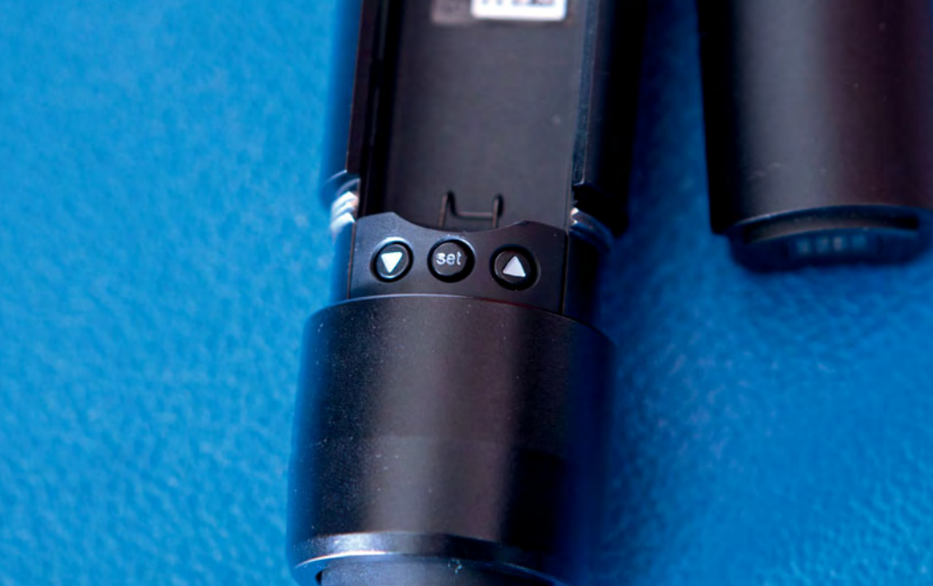
Przyciski sterujące menu nadajnika handheld, tak jak i przycisk włącznika, znajdują się pod odkręcaną tuleją na końcu korpusu, zabezpieczającą je przed przypadkowym naciśnięciem.
