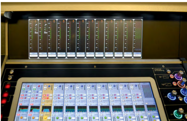
Dwa z 5 wyświetlaczy LCD konsoli SD5 pełni rolę interaktywnych meterbridge'ów (IDM).
