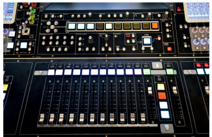
Znany z konsol SD7 panel centralny z przeprojektowanym zestawem przycisków, znajdujących się teraz bardziej „pod ręką”.
