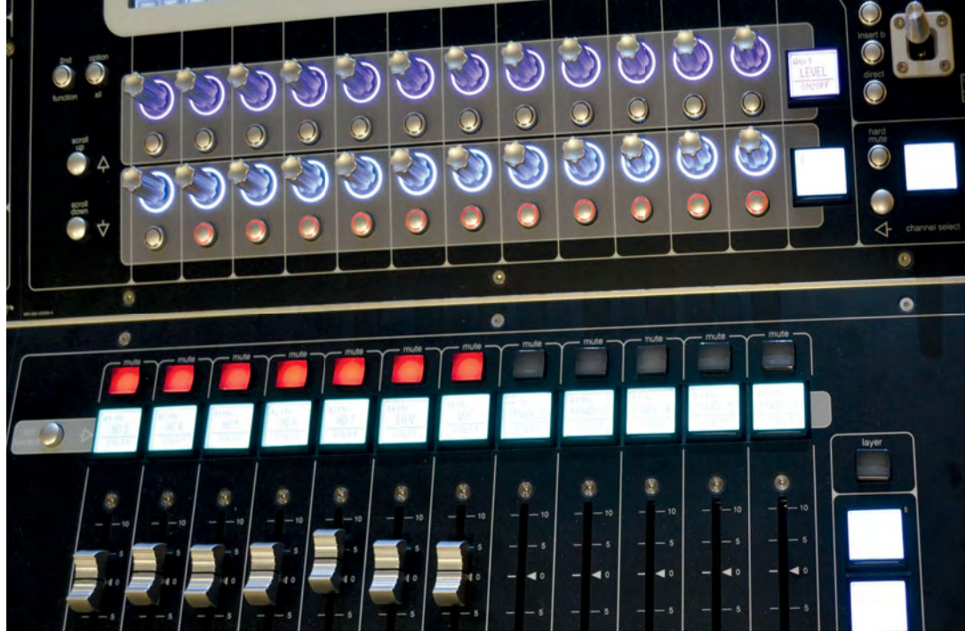
Orientację „w terenie” ułatwiają podświetlenie obrotowych enkoderów HTL w kolorze odpowiadającym realizowanej przez nie w danym momencie funkcji.
